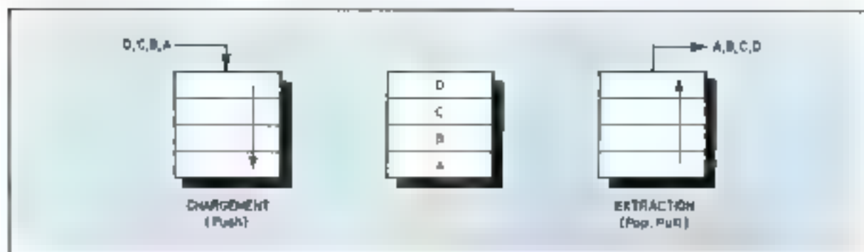
Fig. 1. - Exemple de pile LIFO. La dernière donnée numérotée (D) sera la première retirée lors de l'exécution.
